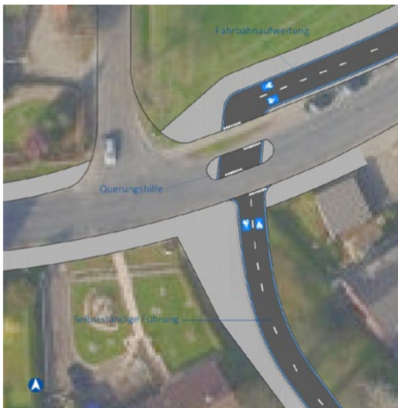
Abbildung 78: Exemplarische Knotenlösung Salzgitter - Querung Danziger Straße
