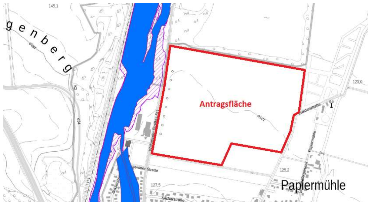
Abbildung 3.5-2: Überschwemmungsgebiete bei Wiedelah. HQ100 und HQextrem 6
