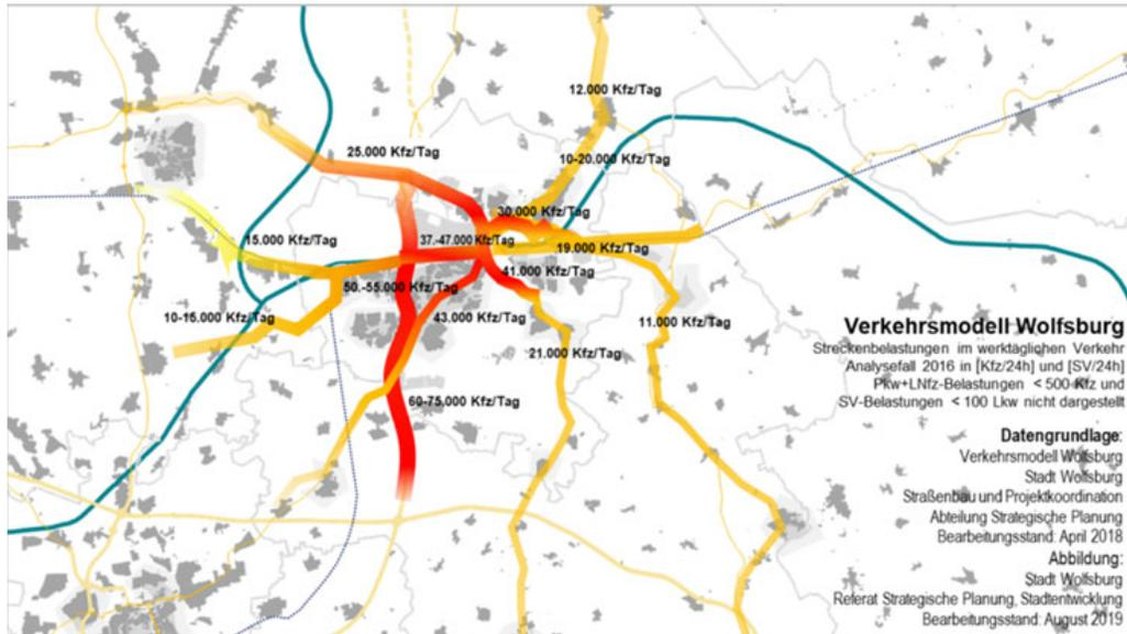
**Abb. 10: Streckenbelastungen im werktäglichen Verkehr von Wolfsburg 2016 (KFZ/24 Stunden)**
