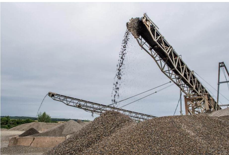
Abb. 2: Kieswerk Heiningen- Bandabwurf
