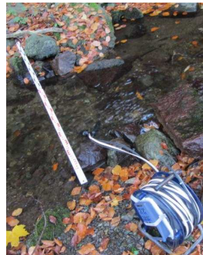
Abbildung 7: Messung der elektrischen Leitfähigkeit, des pH-Wertes, der Temperatur und des gelösten Sauerstoffs mittels einer Multiparametersonde
