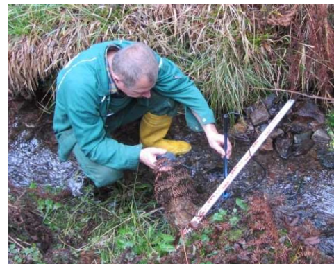
Abbildung 6: Links: Darstellung eines Messquerschnittes, rechts: Abflussmessung mittels hydrometrischen Flügels
