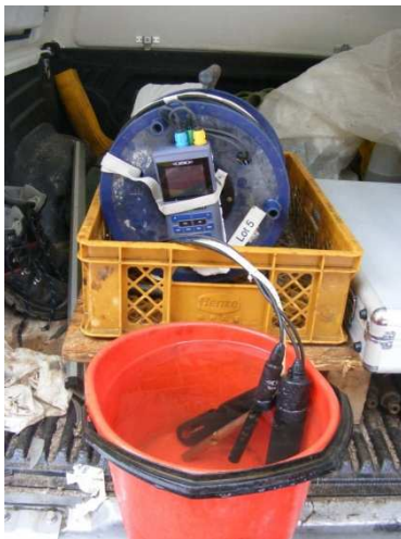
Abbildung 7: Messung der elektrischen Leitfähigkeit, des pH-Wertes, der Temperatur und des gelösten Sauerstoffs mittels einer Multiparametersonde
